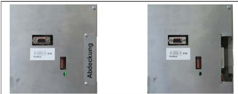
Abb. 4.14: Einbauort der Compactflash-Karte
