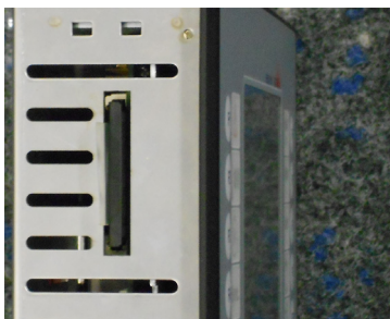
Abb. 4.14: Einbauort der Compactflash-Karte REDIS 180 und REDIS 220
